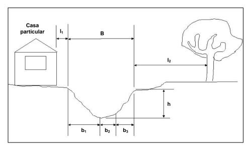
Figura 1.19 Levantamiento de una sección crítica para un cauce natural
