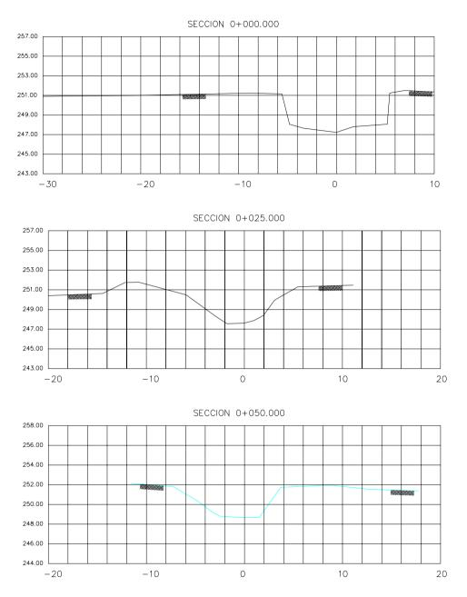
Figura 1.25 Secciones transversales del arroyo a cada 25.0 m
