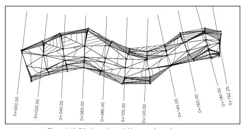
Figura 1.18 Dibujo en planta del levantamiento de un arroyo
