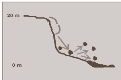
Figura 4. Esquema de un caído o derrumbe
