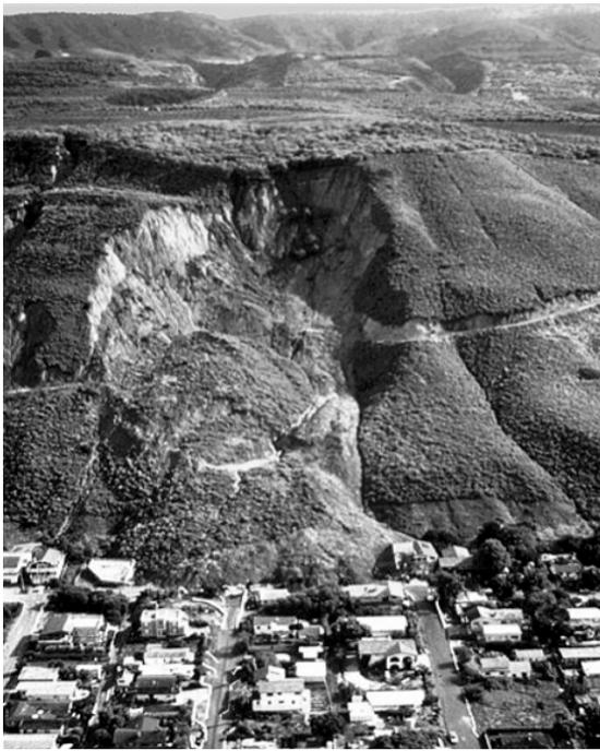
**Figura 9.** Deslizamiento rotacional la Conchita, en California
