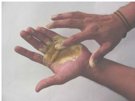
**Figura 1.12 Método “consistencia cerca del límite plástico”**
