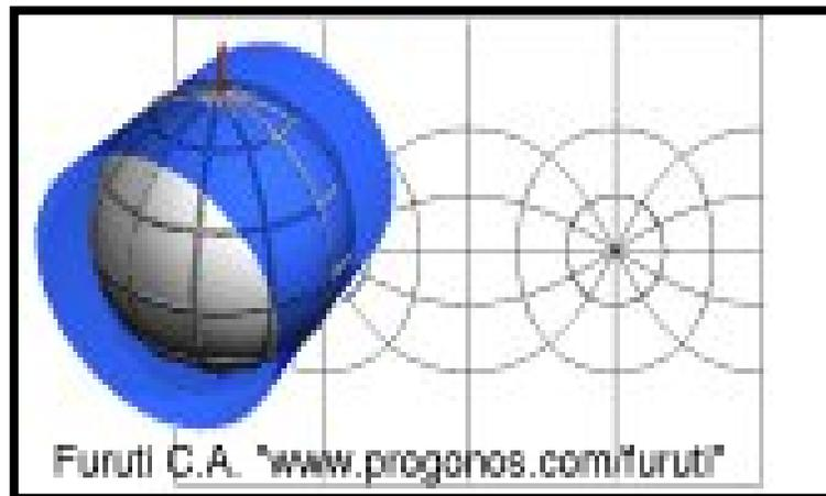
Proyección Cilíndrica en posición Tangente (Oblicua)
