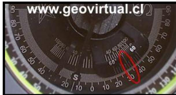
El clinómetro muestra con la escala correspondiente el valor en la foto alrededor de 33°.
