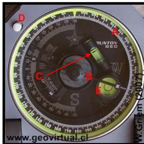
Brújula con escala azimutal contrarreloj
