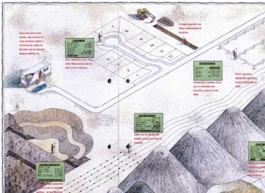
Figura 1.2: Replanteo topográfico
