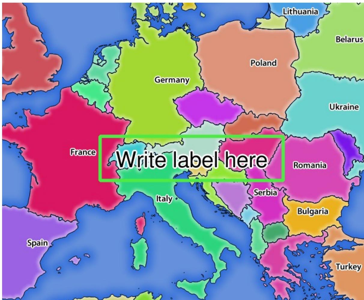
Figura 3.7: Respuesta del servidor a una solicitud GetMap con parámetros de marcado
