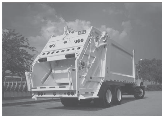
c) El vehículo de carga trasera se utiliza para la recolección habitacional.
