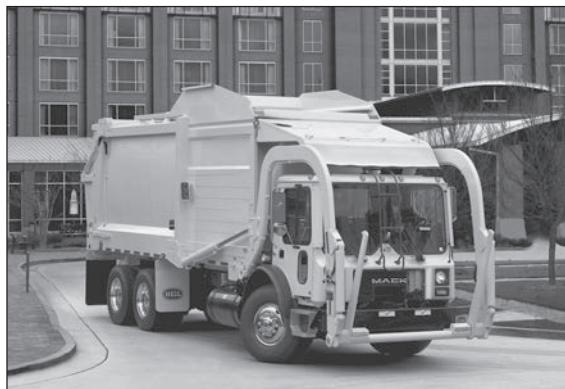
a) Este vehículo de carga frontal es comúnmente utilizado para la recolección comercial.
