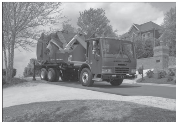
b) Este vehículo de carga lateral es comúnmente utilizado para la recolección habitacional.
