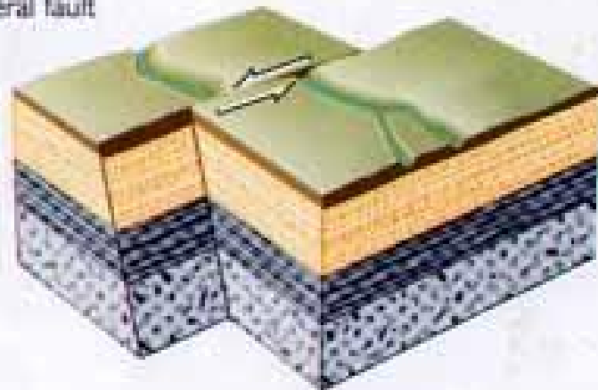
Falla de desplazamiento lateral
