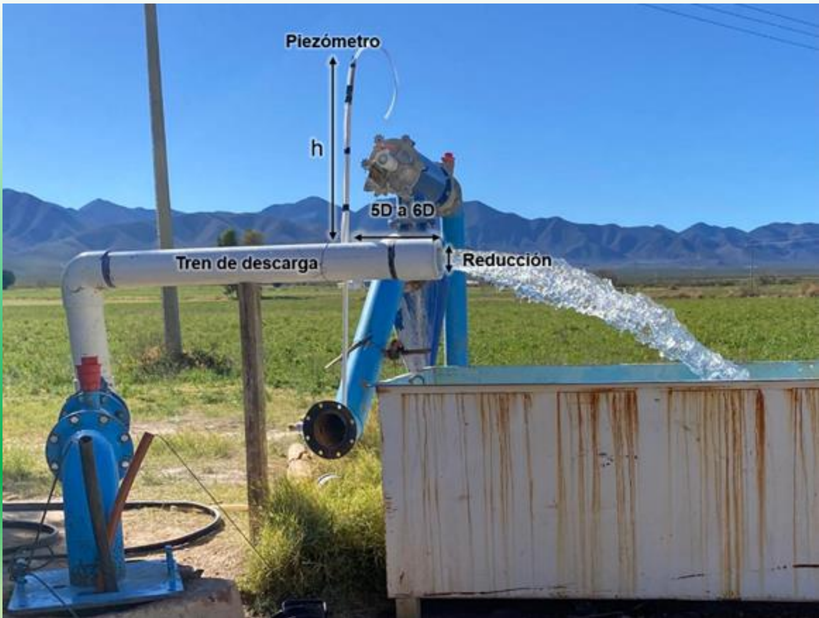
Método del orificio calibrado en un pozo.
