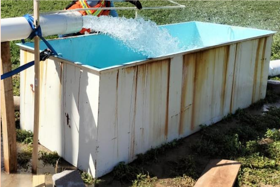
Recipientes utilizados para el aforo volumétrico. a) Una tina con capacidad de 3000 l. b) Una cubeta con capacidad de 19 l
