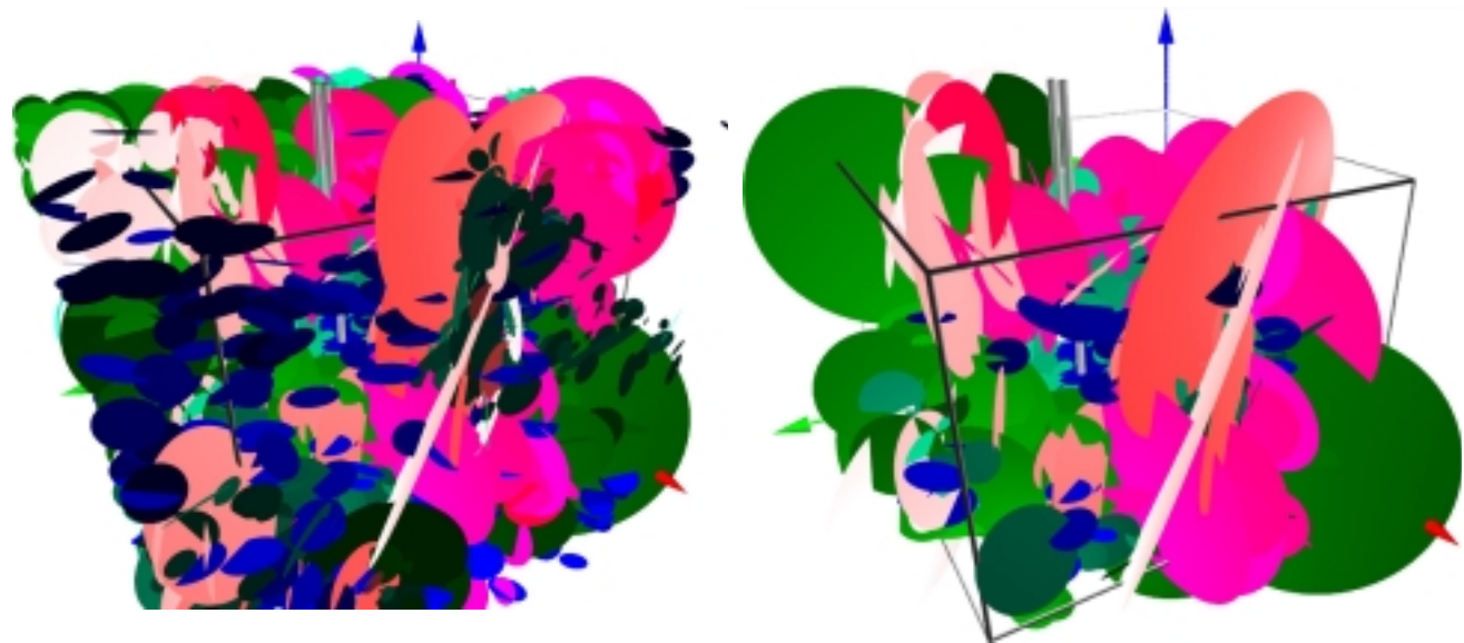
Figura 3: Red de fracturación generada externamente (izquierda) y red de fracturación conductiva generada por FRACAS (derecha). Cada una de las seis familias tienen un color distinto (p.ej. los discos negros es la Familia H) y los cilindros centrales que sobresalen del dominio simulan los sondeos S14 y S18. El eje derecho es el Norte-Sur o X, el izquierdo es el Este-Oeste o Y y el superior es el vertical o Z.
