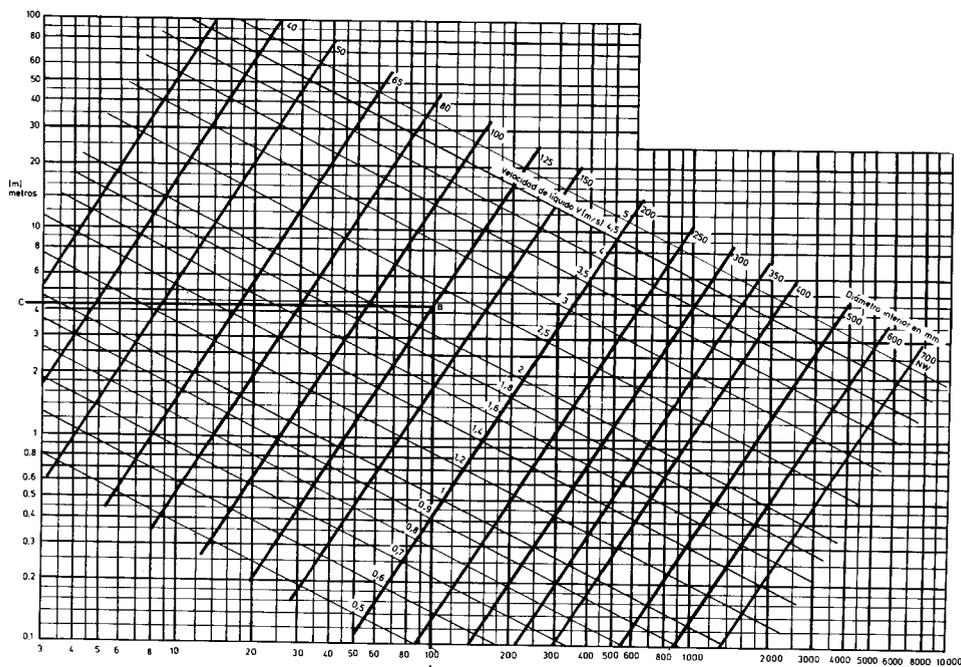
Gráfico 80.—Pérdidas de carga en tuberías y velocidad de circulación por el interior de las mismas.
