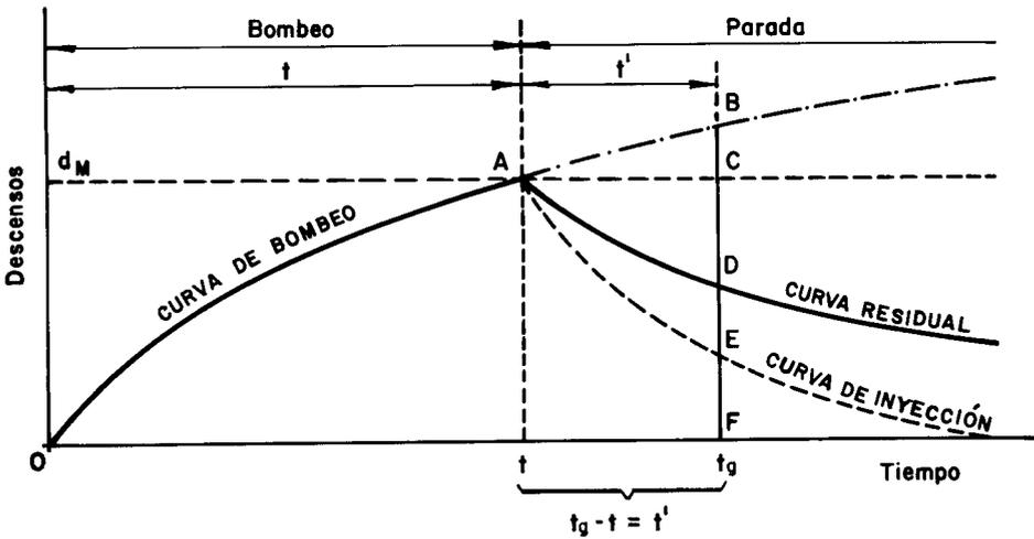
Fig. 9.—Esquema para la deducción del valor del descenso residual  $d_r$  en el análisis de la recuperación de niveles posterior a la parada.
