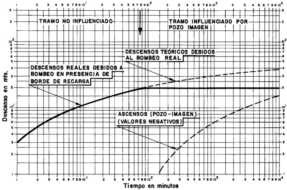
Gráfico 33.—Curva  $\lg d - \lg t$  de descensos por bombeo en presencia de un borde de recarga.
