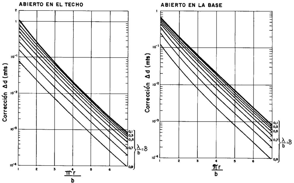
Gráfico 43.—Correcciones de los descensos en piezómetros de observación debidos al bombeo en un pozo incompleto.
