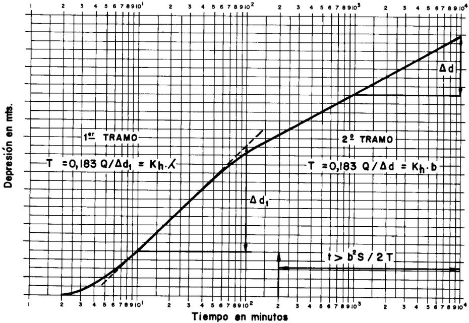
Gráfico 44.—Evolución de descensos en un piezómetro parcialmente penetrante a consecuencia del bombeo en un pozo incompleto.
