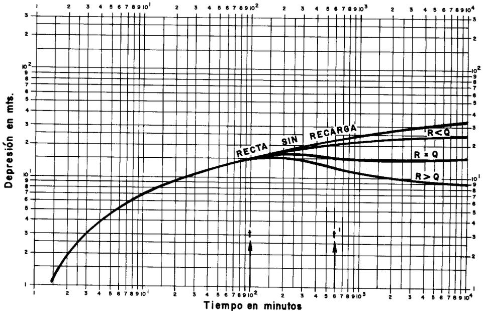
Gráfico 27.—Curvas de campo  $\lg d - \lg t$  con efectos de recarga para distintas hipótesis.
