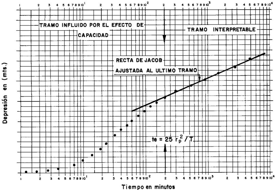
Gráfico 37.—Curva  $d - \lg t$  con efecto de capacidad por bombeo en pozo de gran diámetro.
