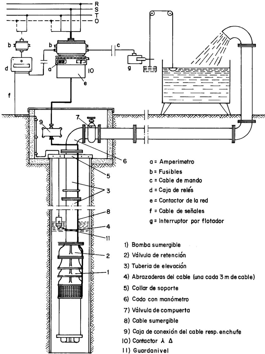
Fig. 34.—Esquema de instalación elevadora.
