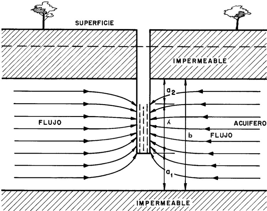
Figura 14.—Esquema de pozo incompleto.
