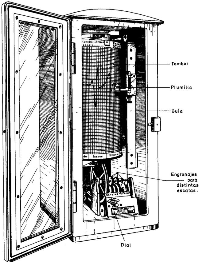
Fig. 23.—Limnógrafo registrador de niveles.
