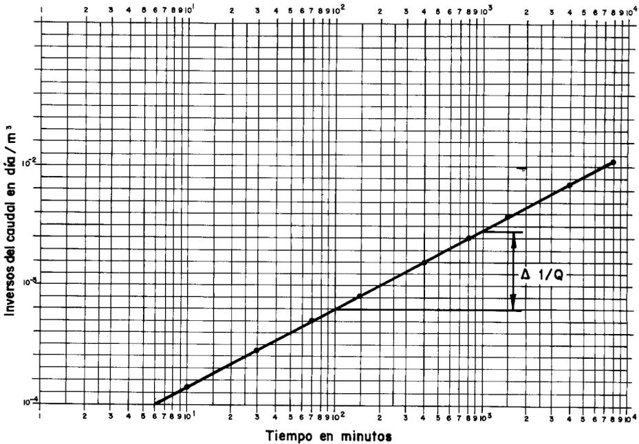
Fig. 38.—Curva de campo  $1/Q - \lg t$  para interpretación de bombeos a caudal crítico.
