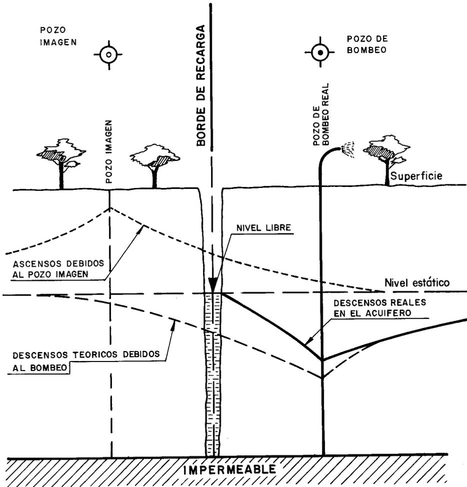
Fig. 12.—Esquema de los efectos de un bombeo en presencia de un borde de recarga (pozo imagen).
