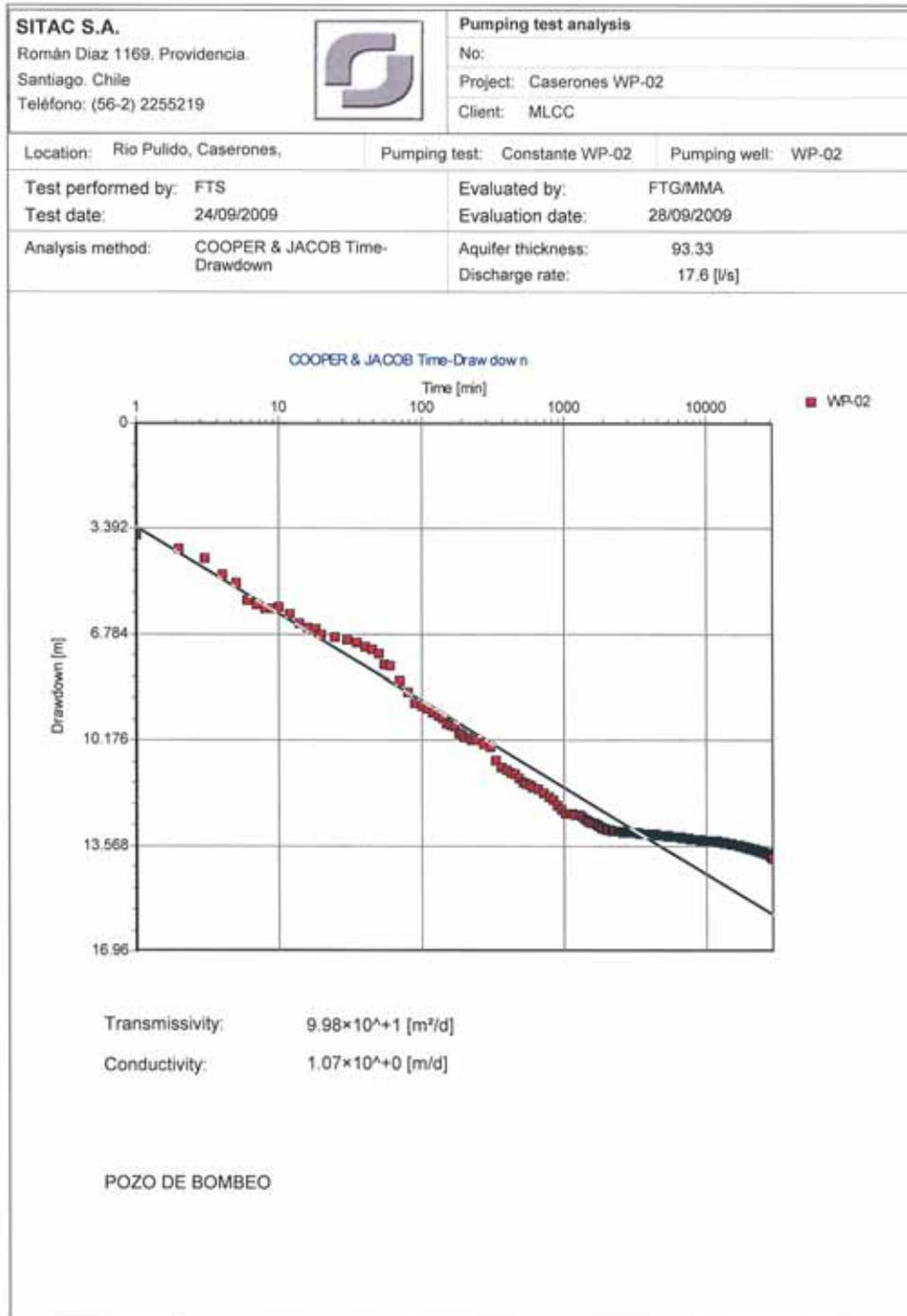
Fig. N° 5: Prueba de bombeo caudal constante, pozo de bombeo.
