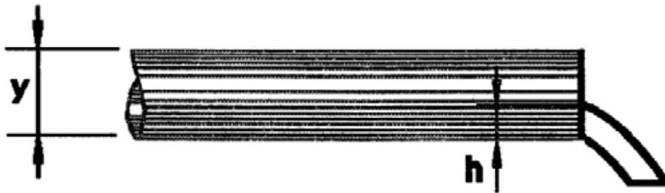
**Figura 2.3. Cálculo del caudal cuando la tubería no está completamente llena**
